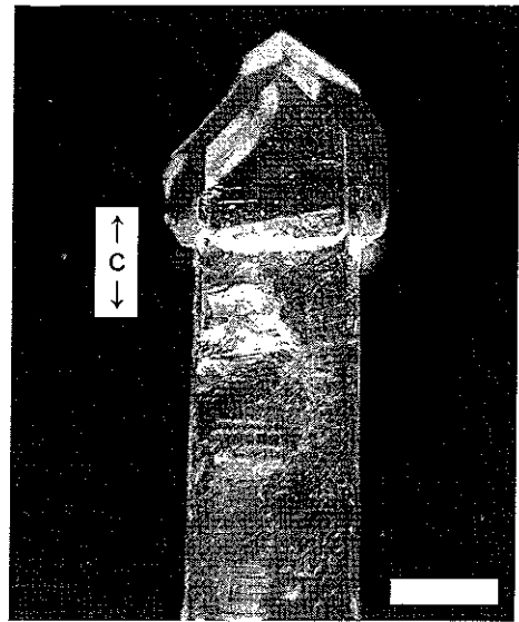
図13： 四角柱状の合成水晶の先端に発生した傘部 スケールは2mm
